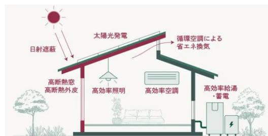
GX ZEHは、遮熱と高断熱構造や樹脂窓の採用によって、住宅性能を大幅に向上させ、室内の温度を安定させます。さらに、高効率な照明器具、給湯器、換気・空調設備、蓄電システムなどを導入することで、生活に必要なエネルギーを最小限に抑えます。
